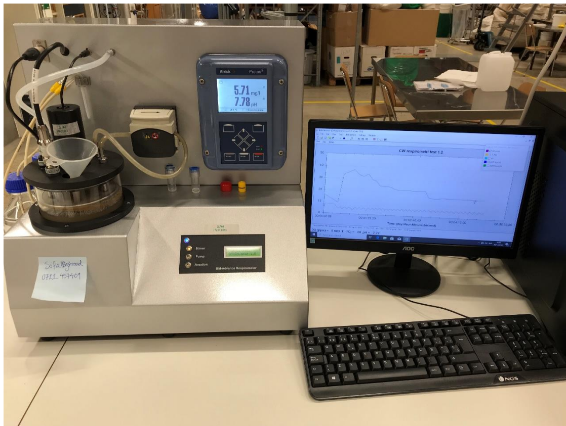
Figur 3. Försökupställning under respirometrieförsöken (en av två reaktorer).
