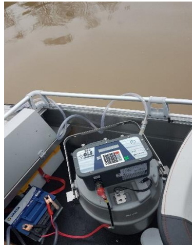
Figur 2. Tidsstyrd ISCO-pump som använts för samlingsprovtagning. Här placerad i båt för provtagning i Lidan.
