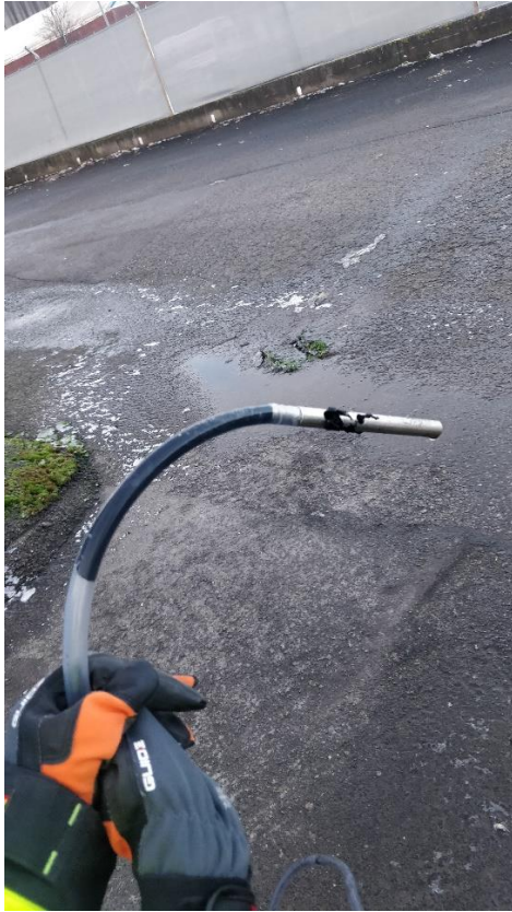
Figur 15. Igensatt munstycke vid dygnsprovtagning av dagvatten på värmeverket. Provpunkt 15, Dagvatten Värmeverket.
