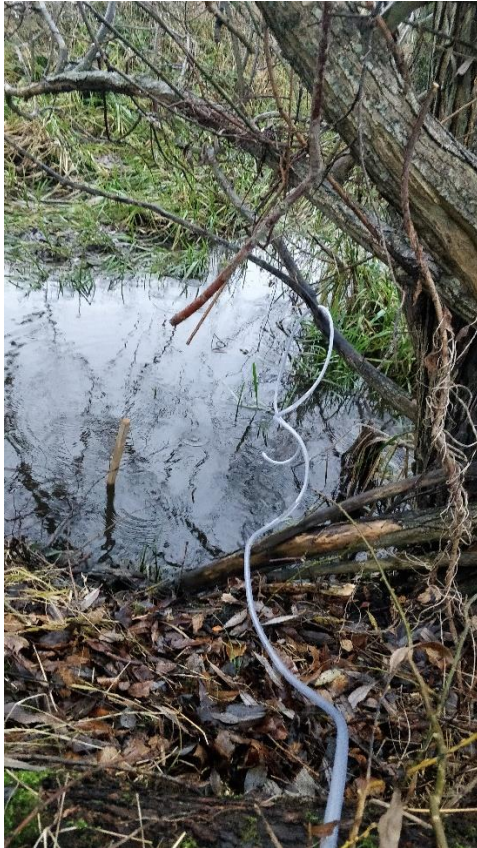
Figur 9. Provtagning med tidstyrd samlingsprovtagare i provpunkt 5, Svartebäcken.
