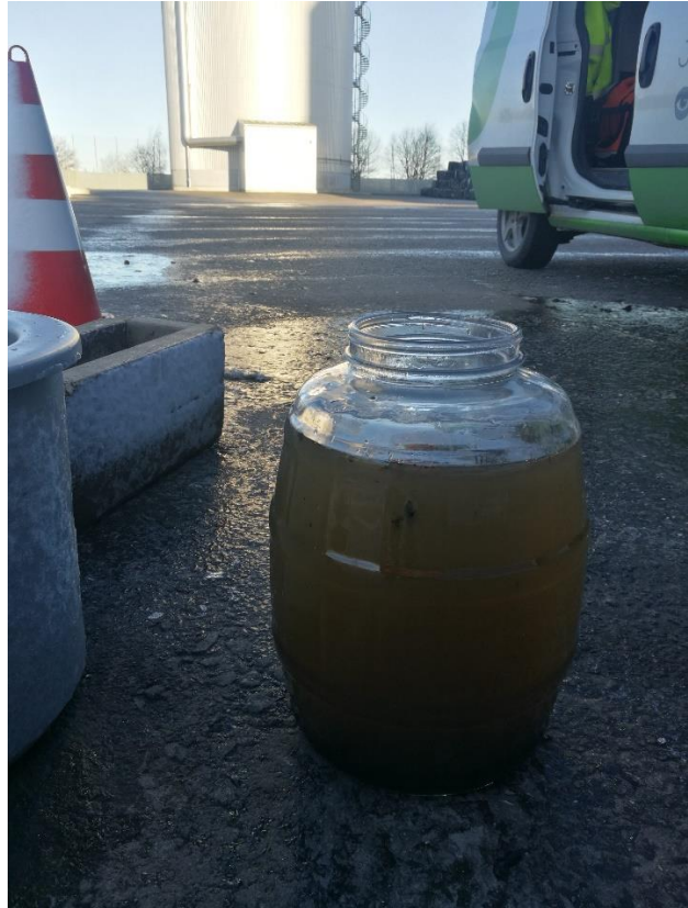
Figur 16. Genererat provvatten vid dygnsprovtagning på värmeverket. Provpunkt 15, Dagvatten Värmeverket.
