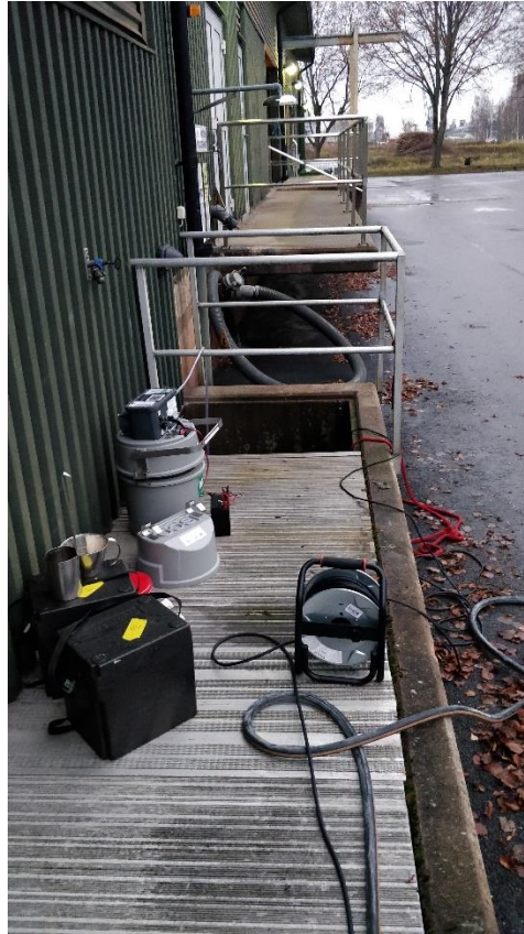
Figur 10. Provtagning med högvolymspump och tidstyrd samlingsprovtagare i utgående vatten från Lidköpings reningsverk. Provpunkt 7, Reningsverket (ARV) utgående.
