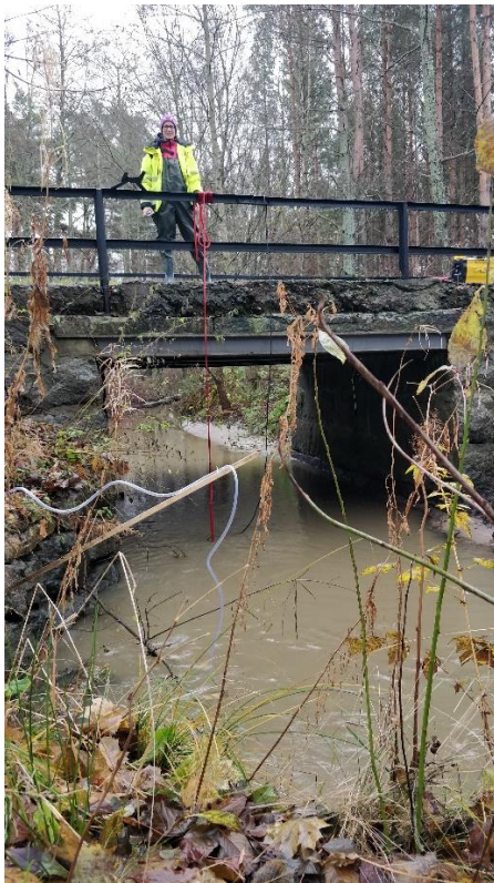
Figur 7. Provtagning med högvolympump och samlingsprovtagare i provpunkt 4, Toftabäcken.
