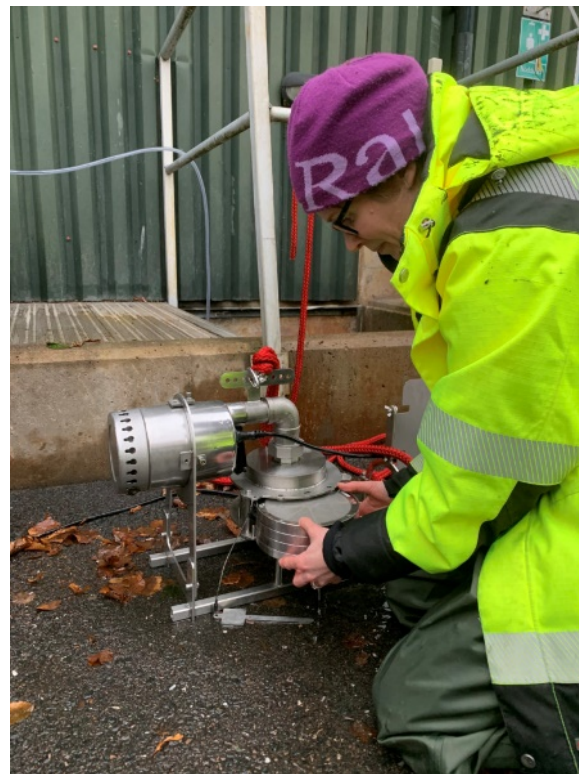
Figur 7. Den lilla högvolympumpen är utrustad med samma filterstack som den stora pumpen och en ram som gör att den kan placeras på botten i grundare vattendrag.
