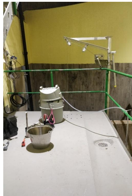
Figur 14. Dygnsprovtagning av avloppsvatten. Provpunkt 10, Pumpstation Älgvägen.
