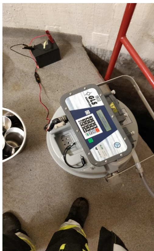
Figur 9. Tidstyrd peristaltisk ISCO-pump som använts vid korttid- och lång tidsprovtagning.
