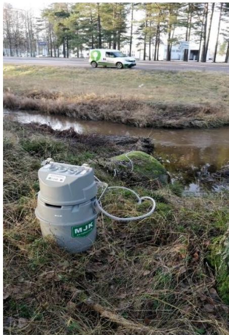
Figur 13. Dygnsprovtagning av dagvatten. Provpunkt 6, Brantabäcken b.
